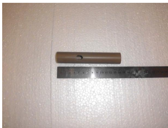
Figura 3. La cabeza con el ovalo de la embocadura
